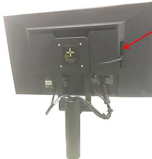
Abbildung 8: USB-Anschlüsse auf der Rückseite des Monitors (verfügbar in einigen ExactVu-Systemkonfigurationen)
