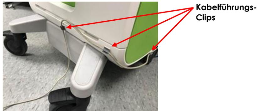
Abbildung 4: Fußpedal-Kabelführung
