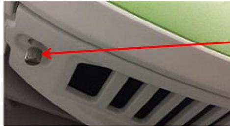
Unverlierbare Schrauben für den Zugang zum Luftfilter
