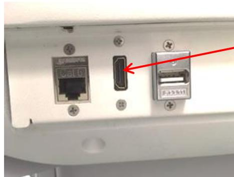
**Abbildung 11: Ausgangsanschluss des zweiten Bildschirms (HDMI)**
